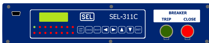
Figura 12 – Ilustração do relé digital SEL 311C.
