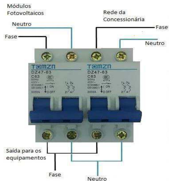
Figura 34: Chave disjuntor de transferência manual.
