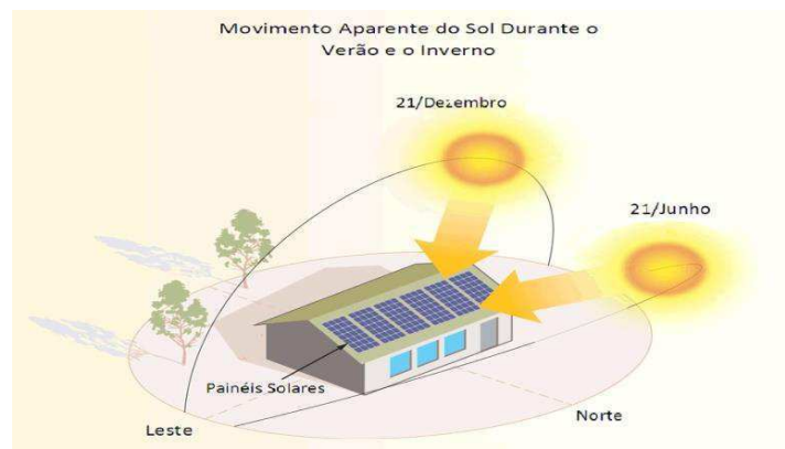
Figura 27: Vista dos painéis fotovoltaicos em relação a orientação geográfica.
