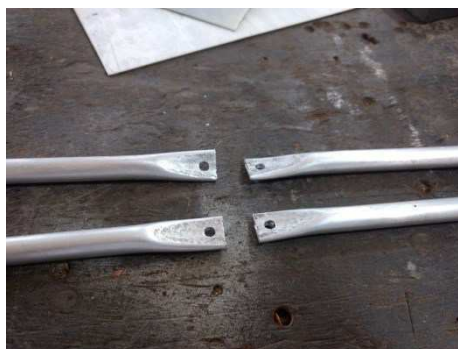
Figura 6.9: Furo para alimentação da antena.
