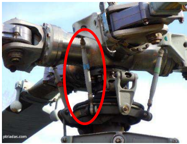
Figura 2 – Hastes de conexão de um helicóptero. Fonte: Hangar MMA
