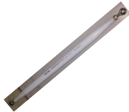
Figura 3 – Exemplo de haste com rótulas nas extremidades. Fonte: Aatoria Própria
