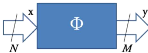
Figura 13 - Compressão do vetor x , reduzido para um vetor y de tamanho M , com M < N pela transformação linear, representada por uma multiplicação pela matriz \Phi ( M \times N ).
