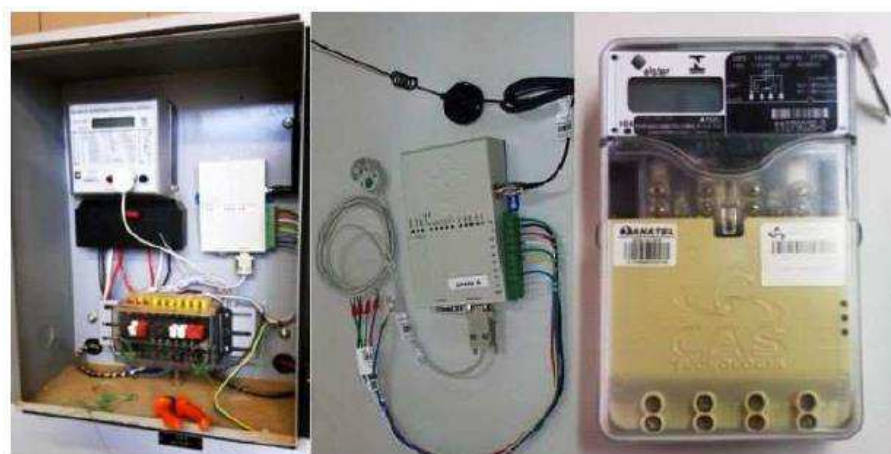
Figura 24 - Conjunto de telemedição, gateway e medidor inteligente.
