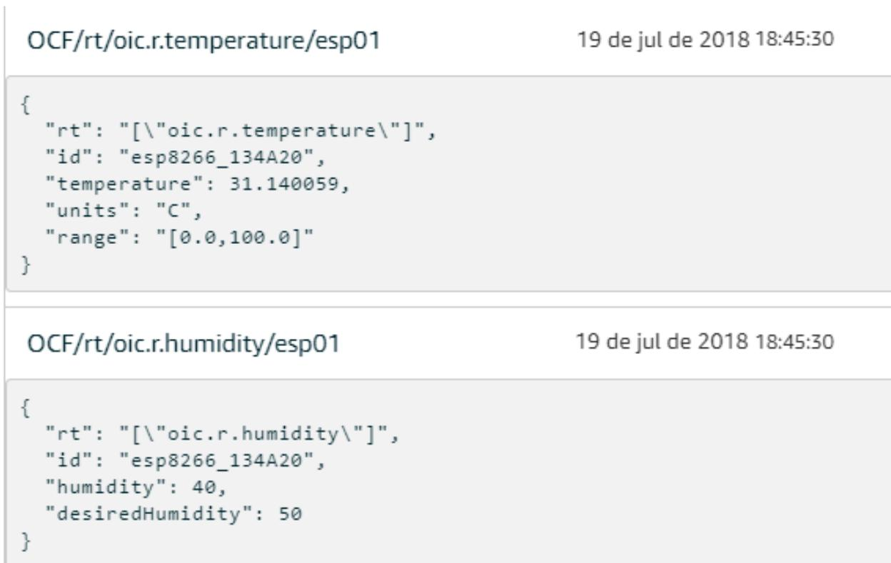
Figura 3.7: Retorno de assinatura no tópico `/OCF/rt/+/(ID do dispositivo)` especificando o dispositivo `esp01`
