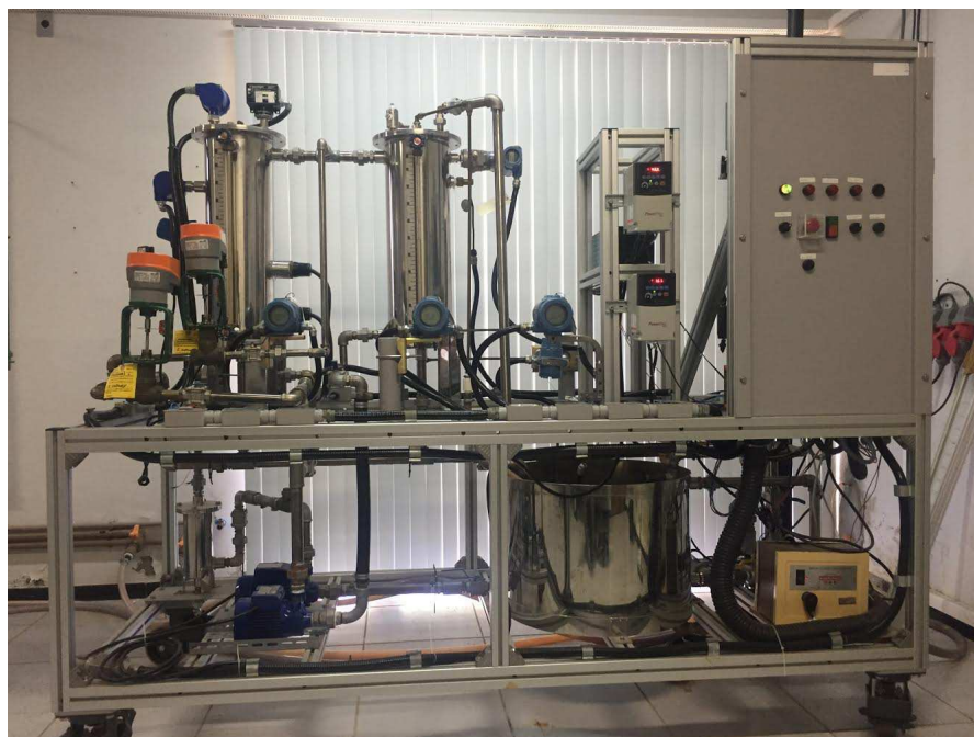
Figura 1 – Planta Didática configurada como evaporador de circulação forçada.
