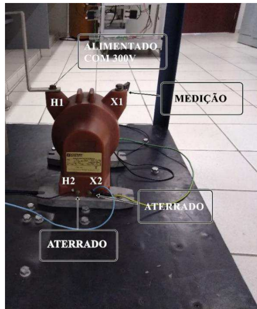
FIGURA 21: MONTAGEM DO ENSAIO 4 COM O TP DE PROTEÇÃO ALIMENTADO COM 300V
