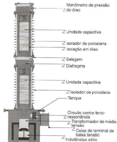
FIGURA 4: TRANSFORMADOR DE POTENCIAL CAPACITIVO
