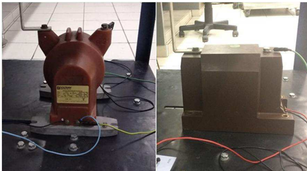
FIGURA 9: TRANSFORMADORES DE POTENCIAL INDUTIVO
