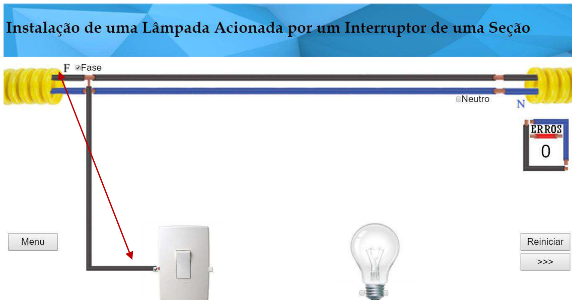
Figura 12 – Conexão realizada entre o condutor fase do eletroduto com o interruptor.
