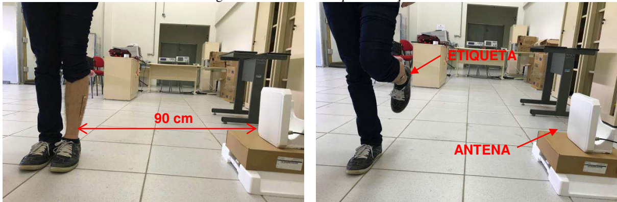
Figura 30 – Terceiro setup de medição.
