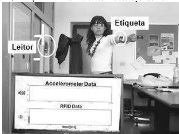
Figura 8 – Etiqueta RFID como sensor na detecção de movimentos.
