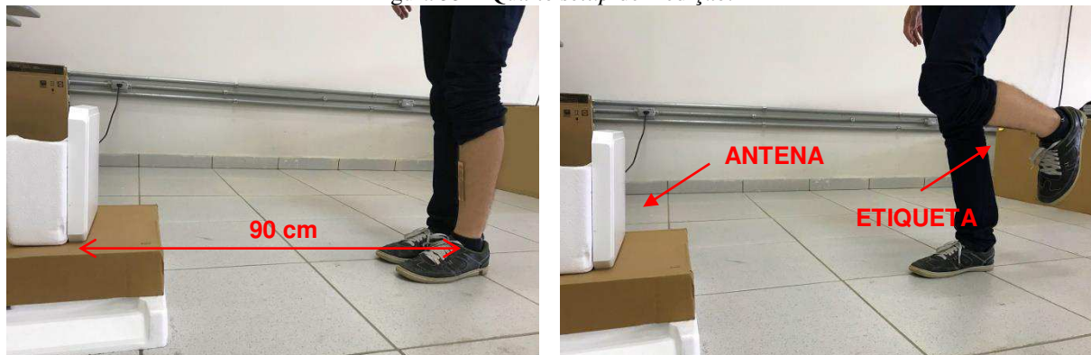
Figura 33 – Quarto setup de medição.
