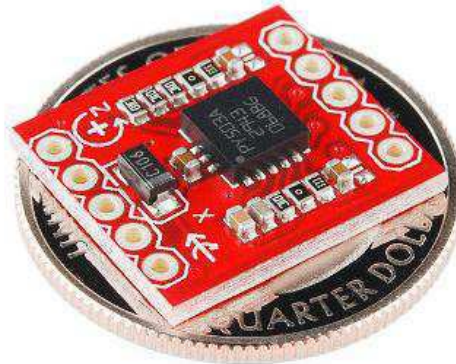
Figura 6 – Placa de desenvolvimento contendo o giroscópio LPY503AL.
