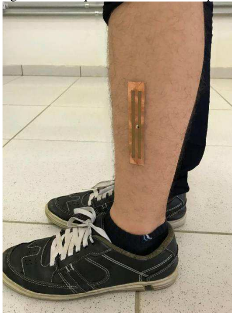
Figura 29 – Etiqueta colocada sobre a perna.
