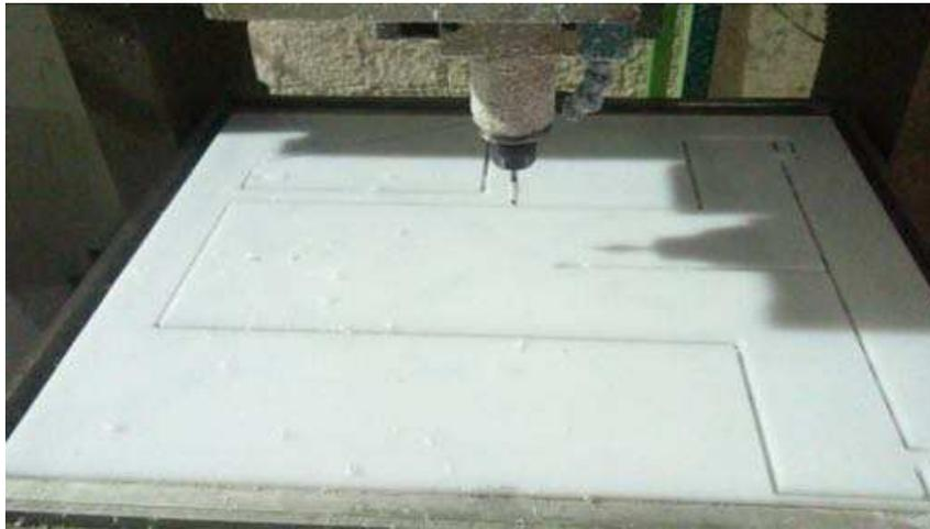
Figura 2.8: Detalhe da peça durante o processo de usinagem.
