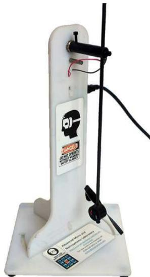
Figura 2.2: Aeropêndulo projetado na Universidade do Arizona.
