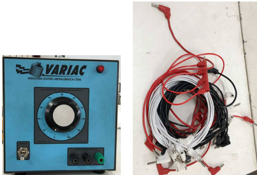
Figura 20 – Variac e cabos para contato.
