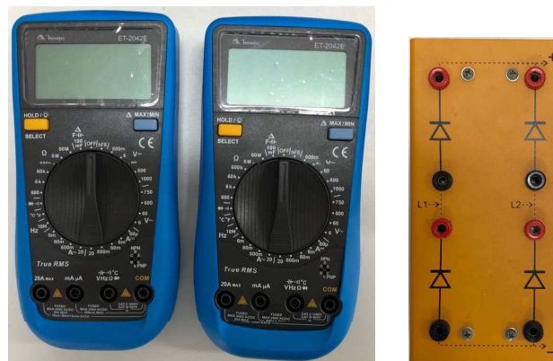
Figura 18 – Multímetros e ponte retificadora monofásica.
