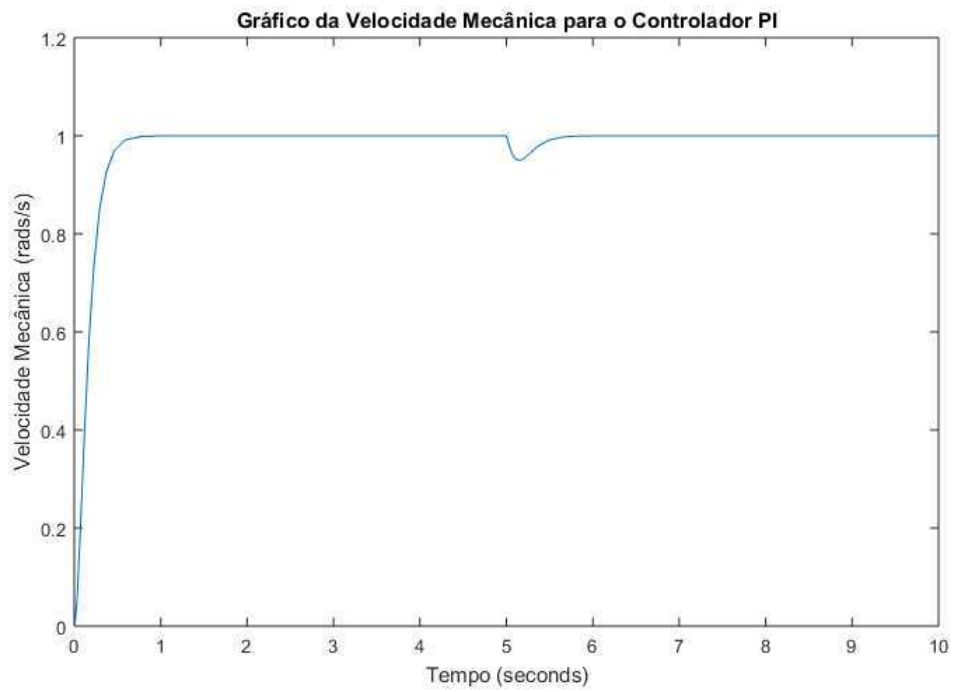
Figura 3.11: Velocidade Mecânica do Motor CC para o Controlador PI - Fonte: Próprio Autor.
