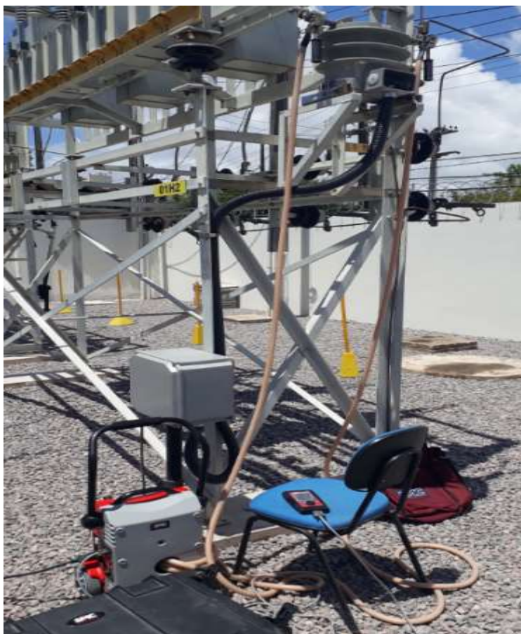
Figura 22: Equipamento injetor SMC Raptor injetando corrente no secundário do TC
