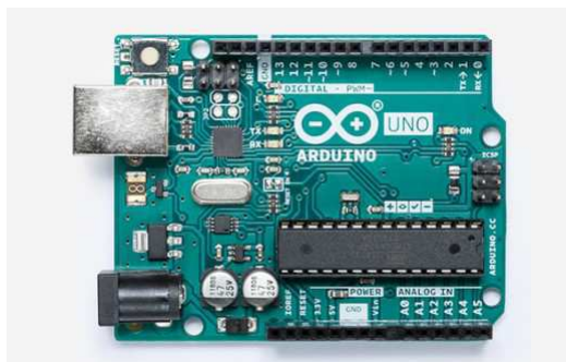
Figura 3.3: Um dos modelos de Arduino Uno disponíveis no mercado [19]
