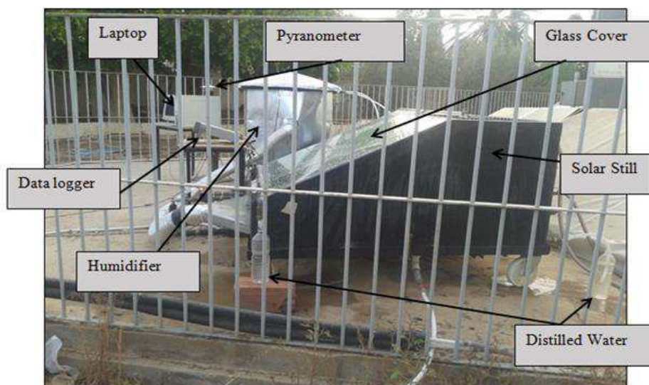
Figura 24 - Configuração experimental do dessalinizador solar
