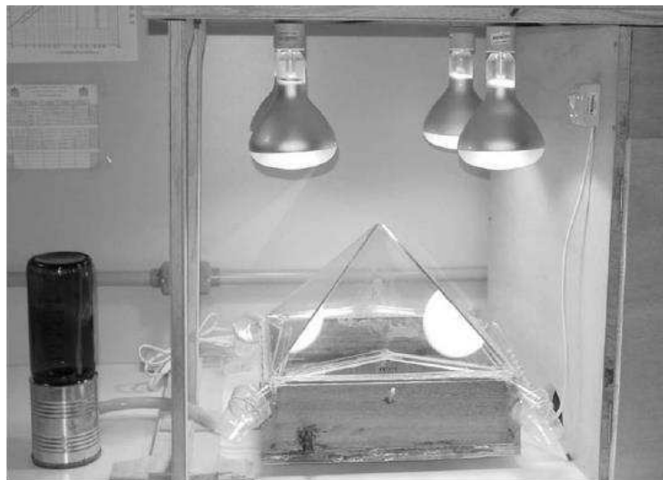
Figura 22 - Ambiente artificial para testar a melhor lâmina d'água
