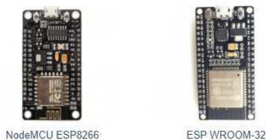
Figura 12 – Placas de Desenvolvimento ESP8266 e ESP32
