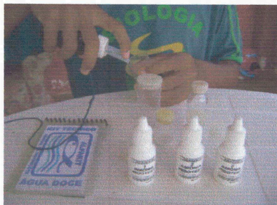
Figura 25 – Reagentes e instrumentos para verificação da amônia
