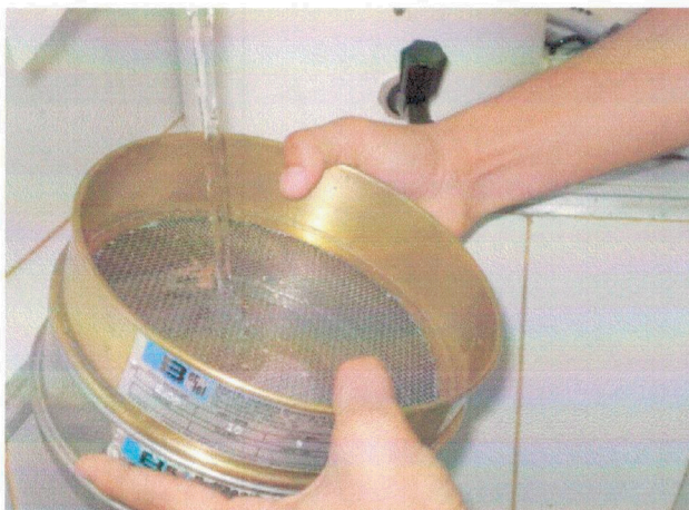
Figura 06: Peneiramento do sedimento para retirada do sal e separação dos tipos de sedimentos.
