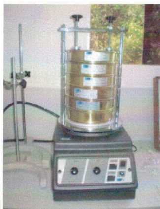
Figura 07 - Peneiramento do sedimento utilizando-se máquina de “rot-up”.
