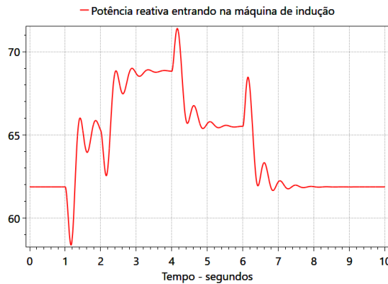
Figura 31 - Potência reativa absorvida pelos aerogeradores
