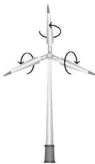
Figura 12 - Representação do sentido de rotação das pás do aerogerador com controle de Pitch .
