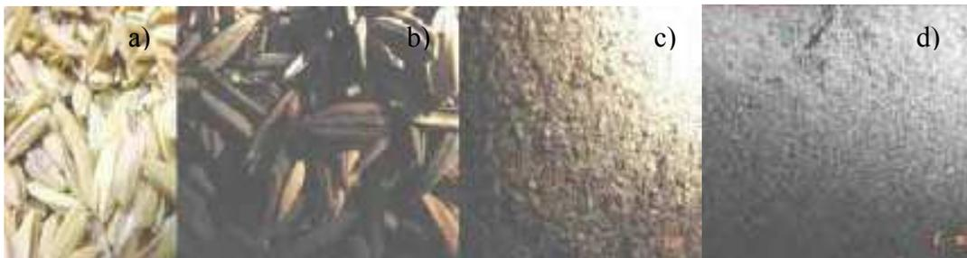
Figura 2.6 – Etapas do processo de fabricação de sílica: a) casca; b) queima 1; c) queima 2 e d) cinza da casca de arroz.
