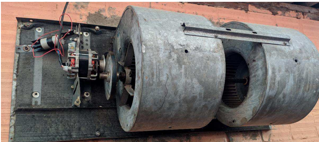
Figura 22: Motor elétrico com enrolamento exposto
