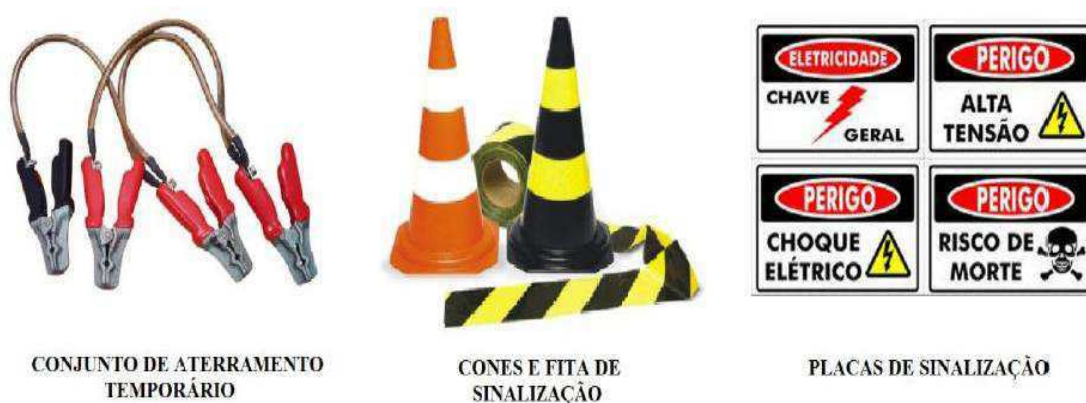
Figura 6: Equipamentos de Proteção Coletiva.
