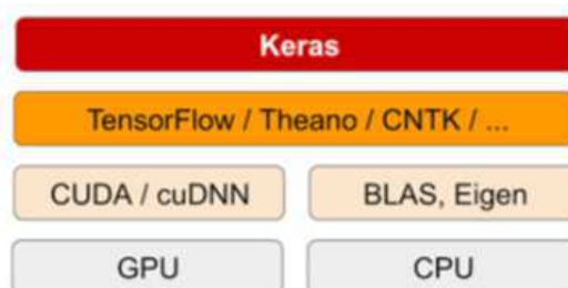
Figura 11 – Camadas inferiores ao Keras, hardware e software [2].
