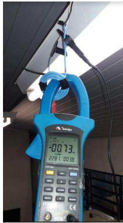
Figura 6 - Alicate wattímetro durante a medição.
