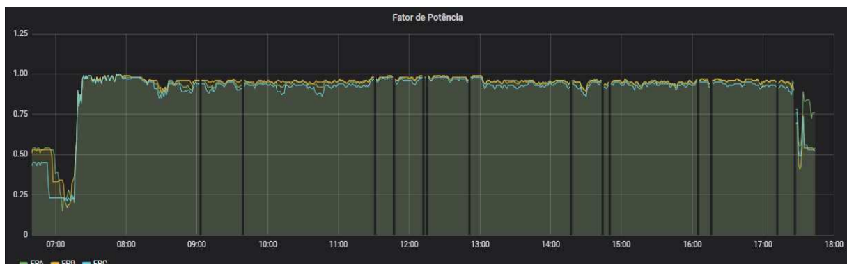
Figura 17: Fator de potência medido na instalação no dia 06 de novembro de 2019.
