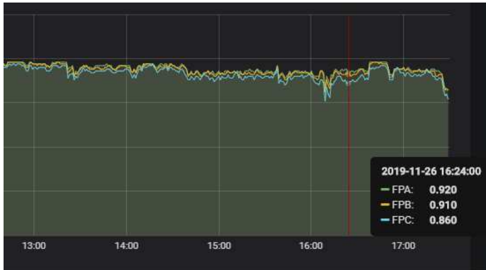
Figura 20: Desequilíbrio de fator de potência na instalação.
