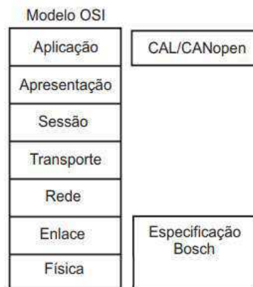
Figura 2.2: Diagrama com as camadas utilizadas pelo protocolo CAN no modelo OSI.
