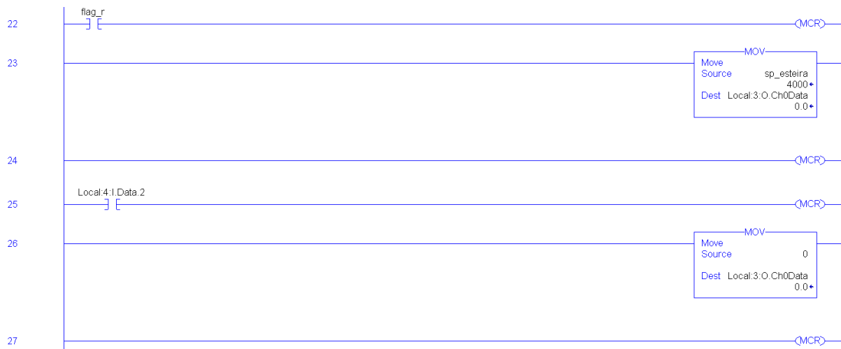
Figura 45: Controle de posicionamento para o objeto depois do módulo de Resfriamento.
