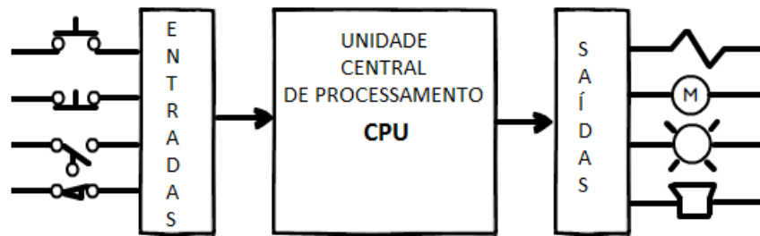
Figura 5: Esquema de uma CPU e sua comunicação com módulos de E/S.
