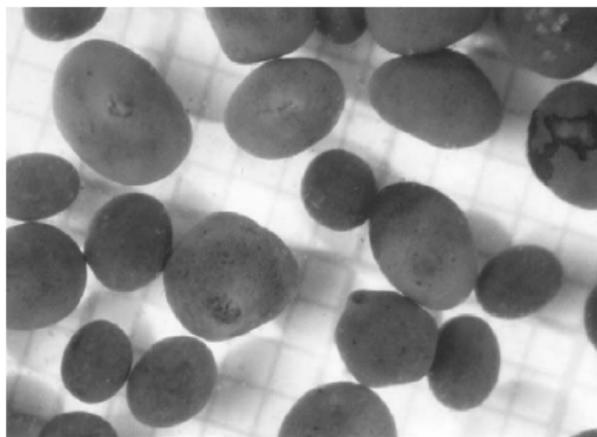
Figura 6 – Grânulos formados em reatores UASB. Fonte: Pol et al. (2004).
