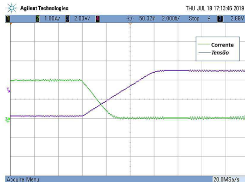
Figura 29 – Sinais de Corrente e Tensão no Fechamento da Chave.
