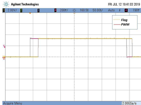
Figura 25 – Sinais de Flag e PWM Sobrepostos.
