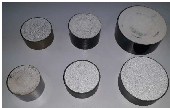
Figura 3 – Varistores de ZnO em diversas dimensões.
