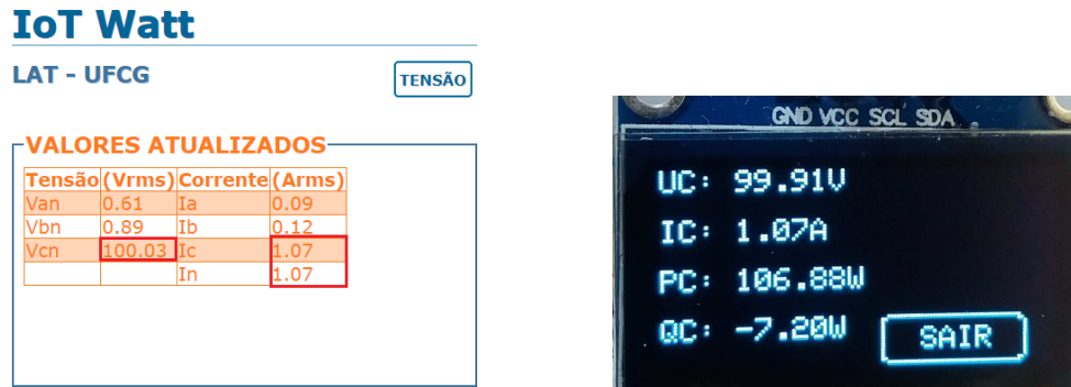
Figura 14: Primeiros resultados para o Wattímetro com ajustes nos ganhos de tensão e corrente.
