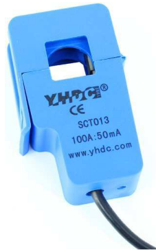
Figura 3: Sensor de corrente não-invasivo.
