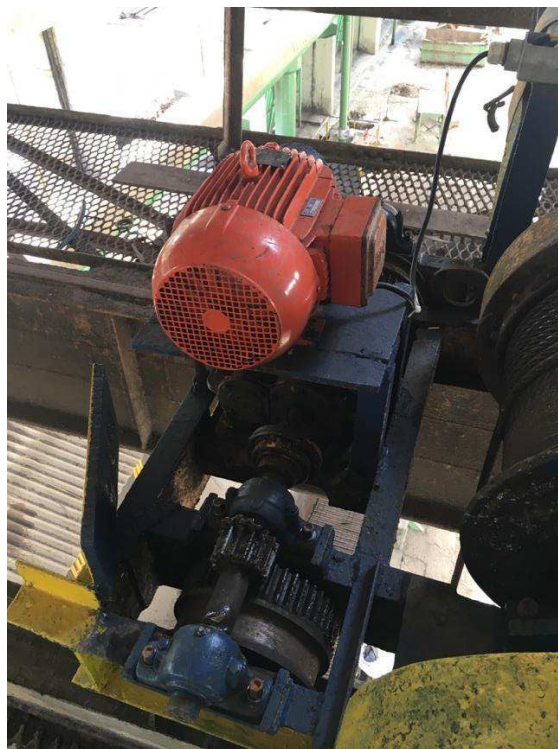
Figura 28 - Sistema de movimentação do carro.
