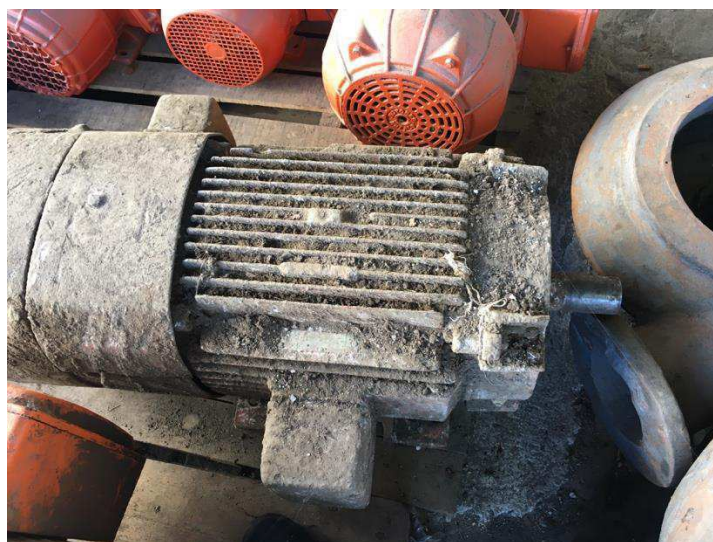
Figura 22 - Motor de rotor bobinado da talha elétrica.
