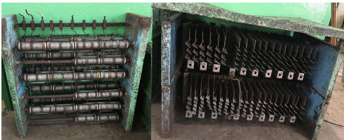
Figura 21 - Banco de Resistores para acionamento de motores.
