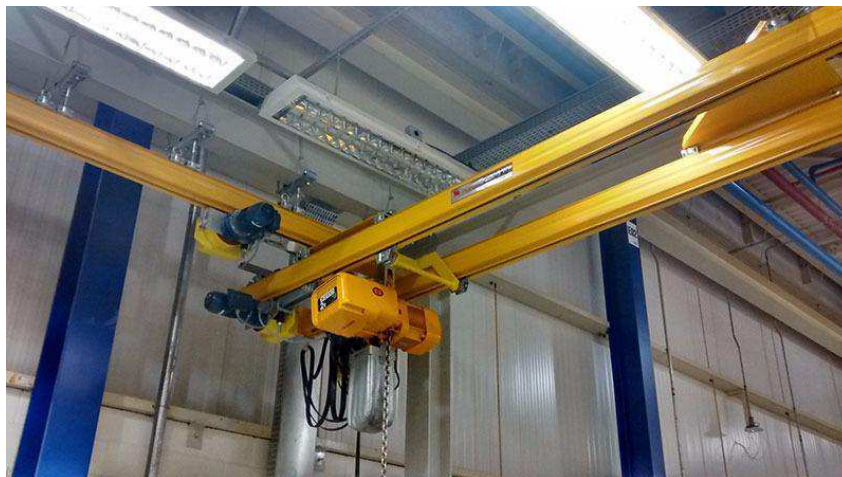
Figura 12 - Ponte Rolante biviga suspensa. Fonte: Catálogo Ponte Rolante Biviga Duren
