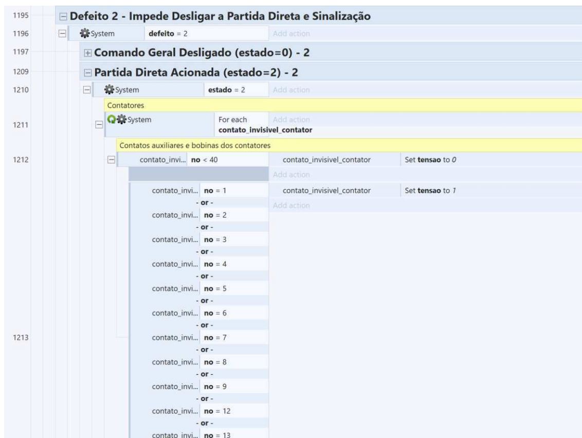
Figura 31 – Trecho do algoritmo de modificação da variável “tensao” associada aos “contatos invisíveis”.
