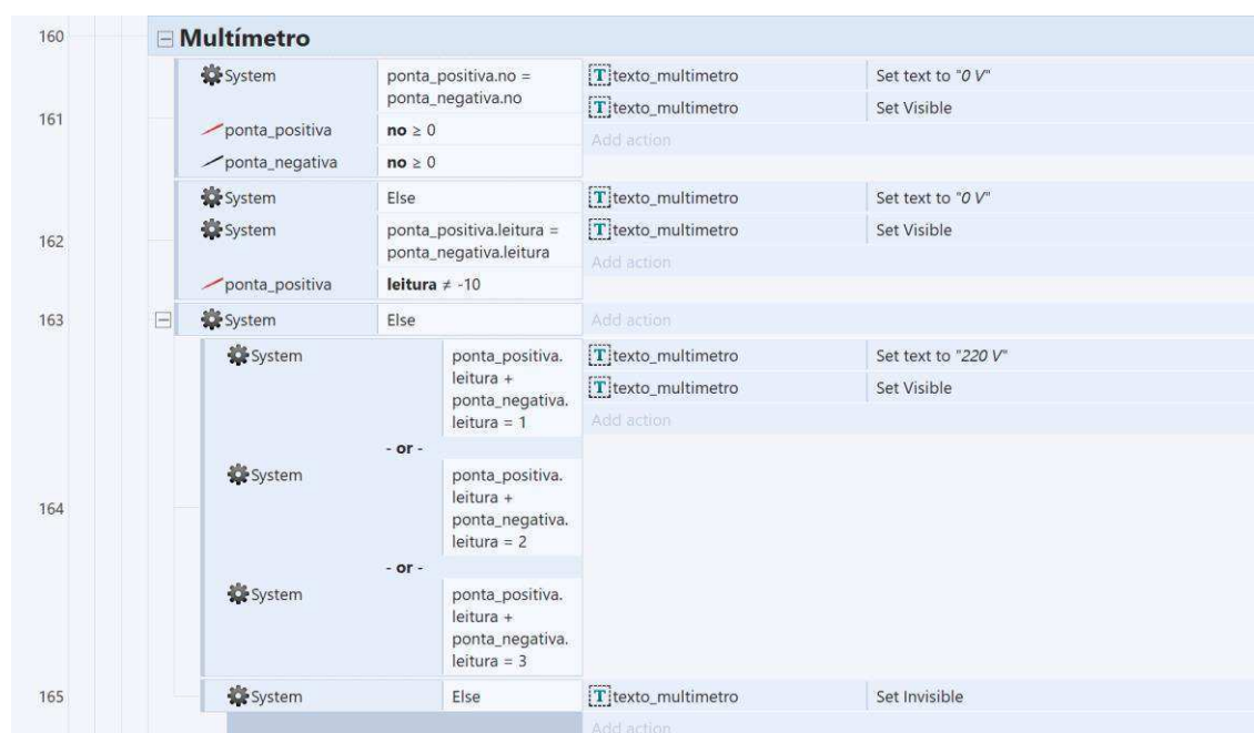
Figura 30 – Testes para determinação do valor exibido pelo multímetro.
