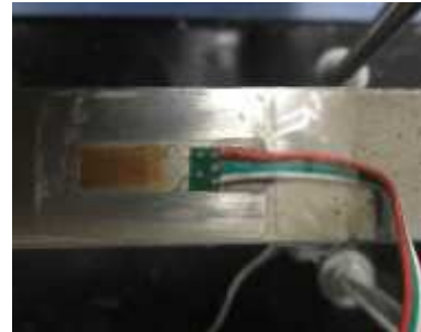
(a) Esquema de Medição de Deformação Utilizando dois Extensômetros (b) Fotografia do Extensômetro Fixado na Viga
