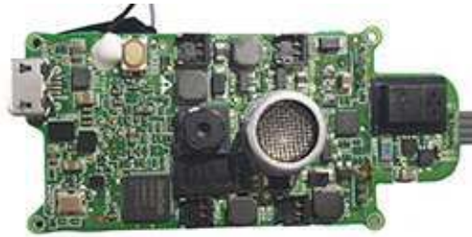
Figura 2.5: Visão inferior da placa de circuito impresso do Parrot Mambo.
