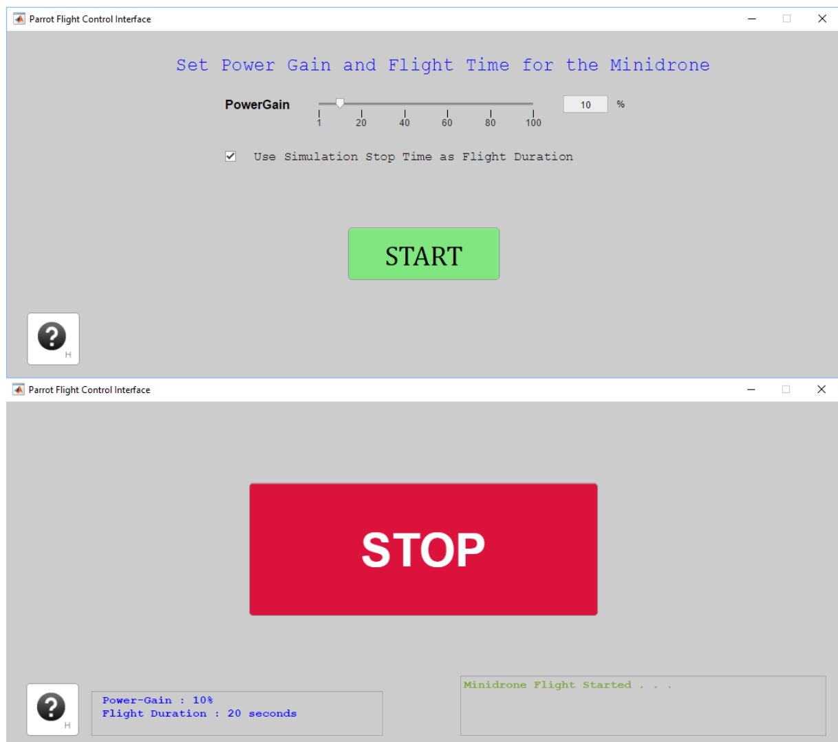
Figura 3.20: Janela da interface de controle de voo aberta após a compilação e envio do modelo em blocos do Simulink para o drone.
