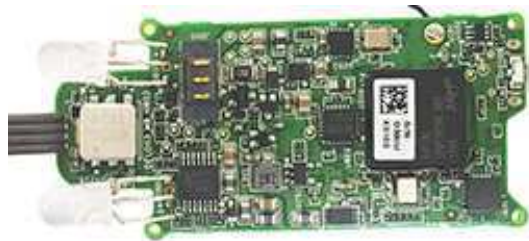
Figura 2.6: Visão superior da placa de circuito impresso do Parrot Mambo.
