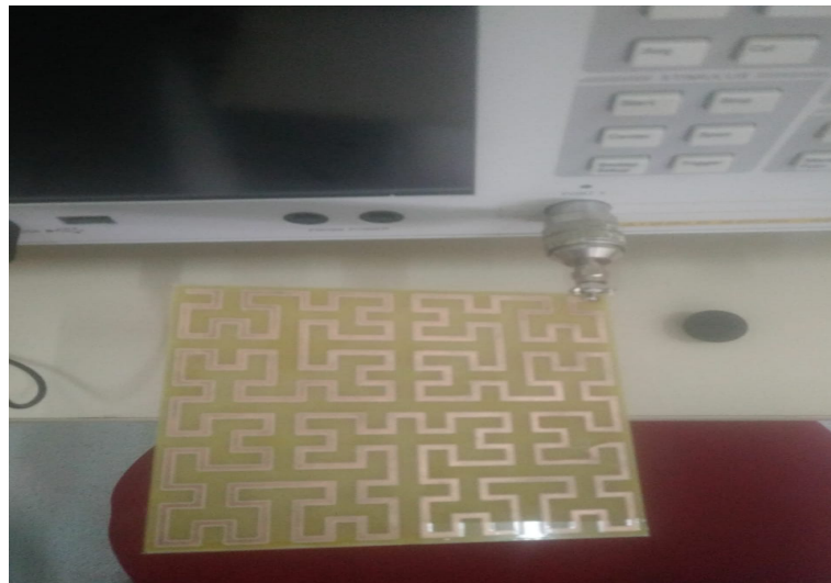
Figura 45: Protótipo da antena fractal de curva de Hilbert, com dimensão de 100 mm x 100 mm.
