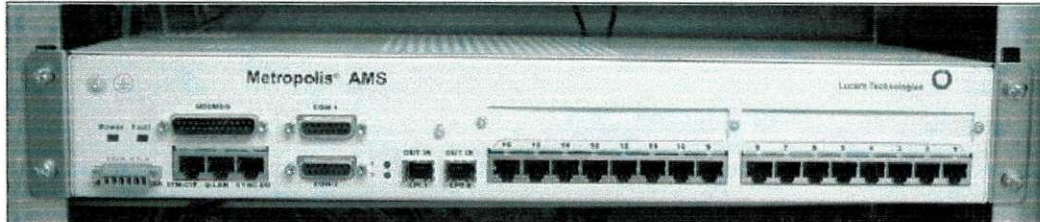
Fig. 03 – Metropolis AMS sem placa opcional em Rack 19" (Fonte: Foto retirada pelo autor).
