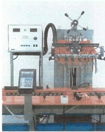
Figura 33 - Teste de curto-circuito. Fonte: http://www.sovema.it/fw_firm.html
