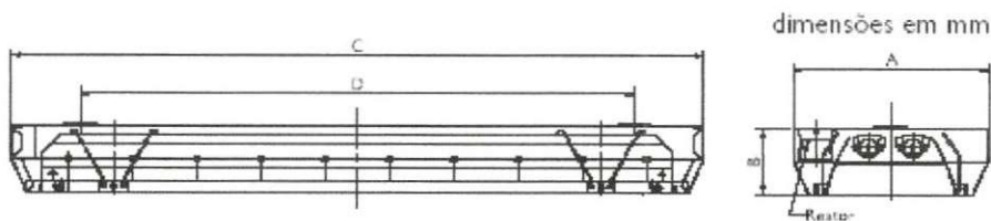
Figura 43 – Dimensões da luminária TCS930/254C5RL
