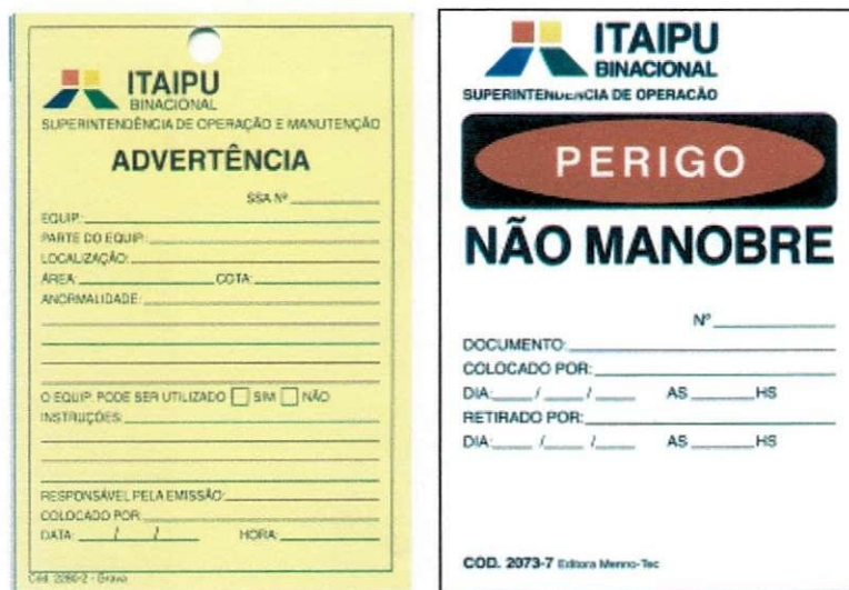
Figura 8 –Cartões Usados para isolamento de equipamentos
