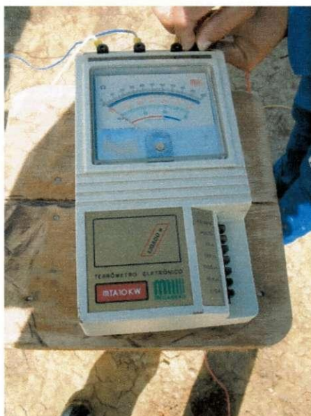
Figura 10: Aparelho para medição da resistividade do solo
