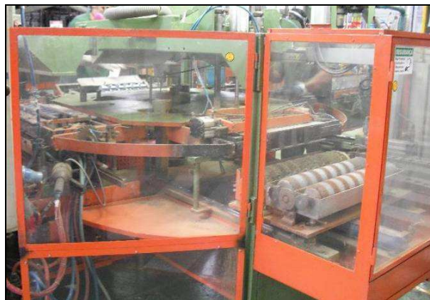
Figura 4.1.7 – Mesa Rotatória Utilizada na Construção dos Elementos
