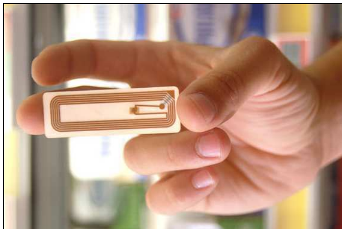
Figura 6.1.2 – Transponder, Etiqueta Inteligente ou TAG
