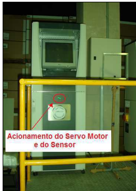
Figura 6.3.6 – Botão de Acionamento do Servo Motor e do Sensor
