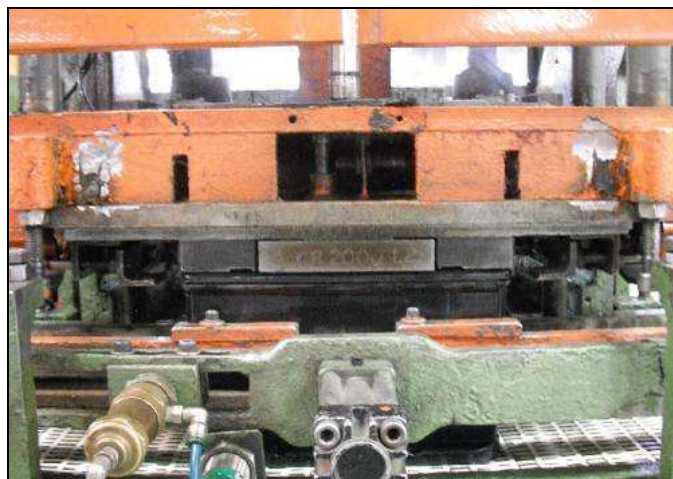
Figura 4.1.9 – Molde Aquecimento utilizado na Selagem Caixa/Tampa
