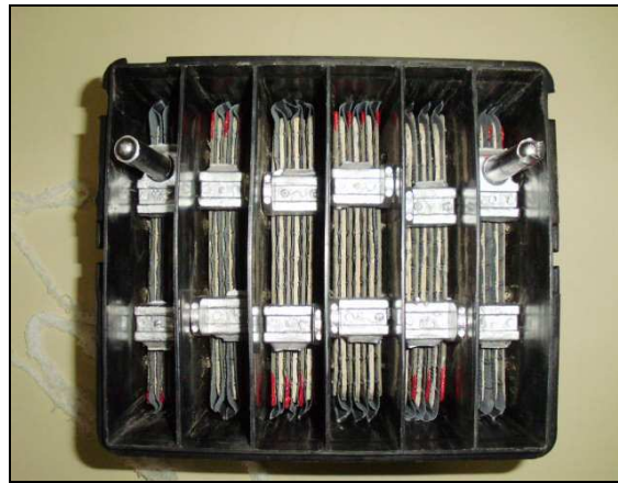
Figura 6.2.3 – Bateria com Placas Positivas Pintadas
