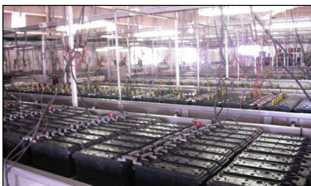
Figura 4.1.10 – Tanques utilizados no Processo de Formação de Baterias
