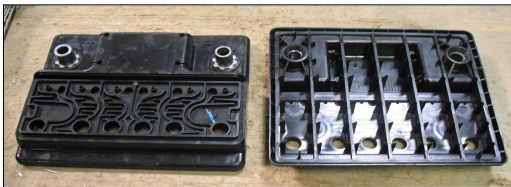
Figura 3.1.2.1 – Tampa com Orifícios de Ventilação
