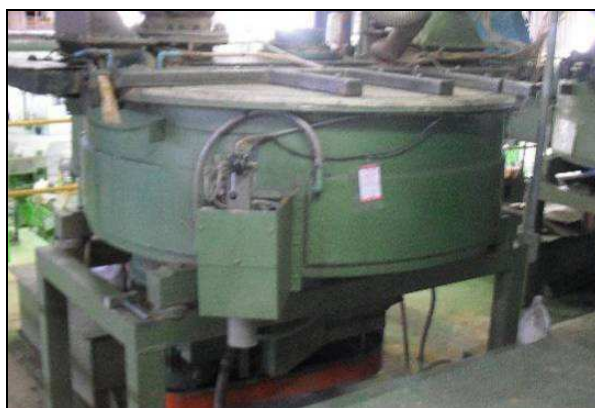
Figura 4.1.4 – Masseira Utilizada na Mistura
