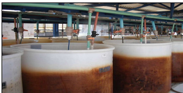
Figura 3.1.5.1 – Tanques para Preparação de Solução de H_2SO_4
