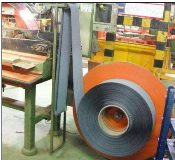
Figura 3.1.4.1 – Separadores Utilizados nas Placas
