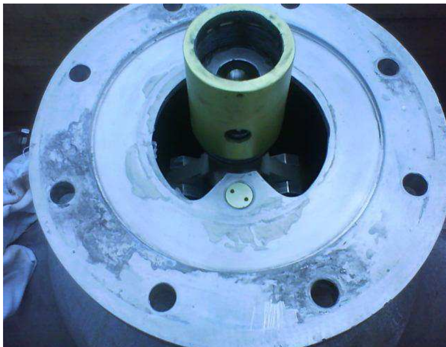
Figura 29: Cárter do mecanismo sem a tampa.
