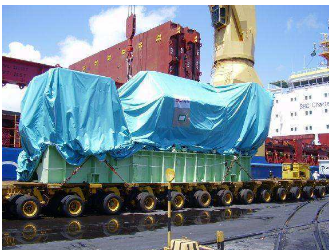
Figura 10 - Fotografia da Carreta de 16 Linhas de Eixo com Grupo Gerador (Fonte: http://rpscom.blogspot.com/2010_01_01_archive.html )
