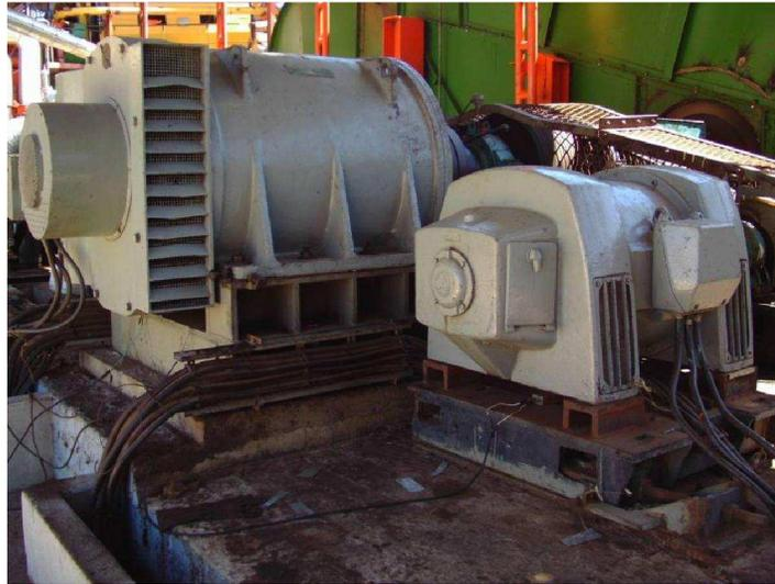
Figura 5 – Motores de grande porte de rotor bobinado
