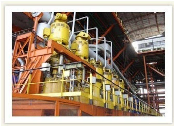
Figura 3 – Centrífugas de açúcar da Usina
