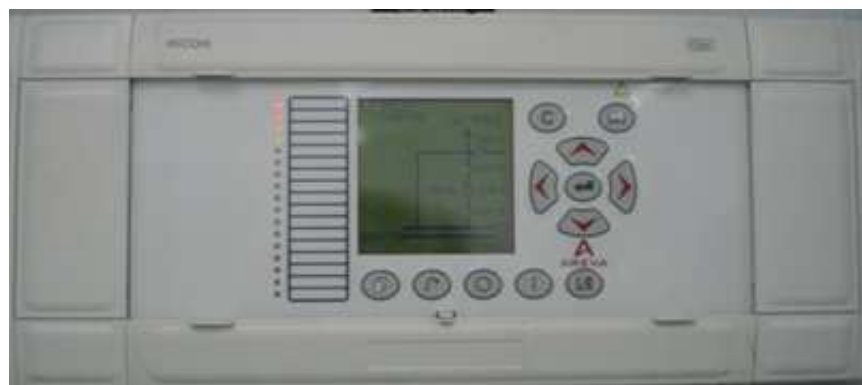
Figura 33: Unidade de Controle MiCom C264
