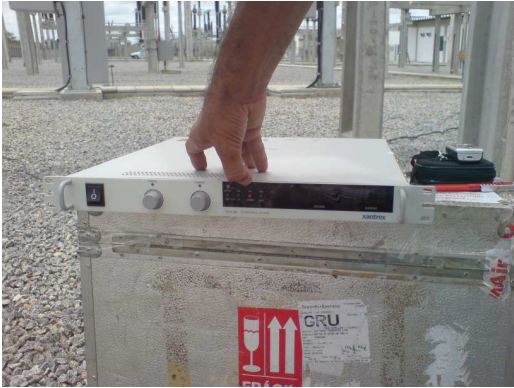
Figura 32 – Gerador de corrente contínua
