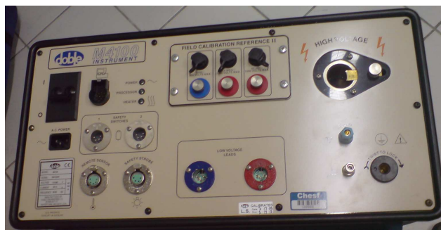
Figura 16 – Medidor de Fator de Potência de Isolamento DOBLE M4100
