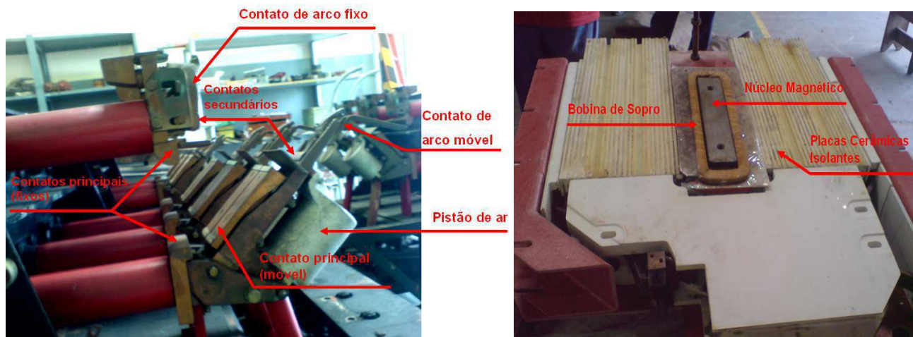
Figura 12 – Os contatos e a unidade interruptora do disjuntor DHE 150 Magrini
