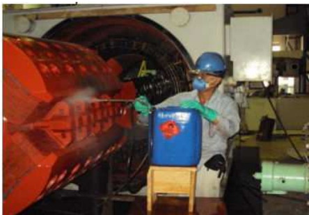
Figura 3.29 – Limpeza do rotor
