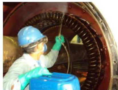
Figura 3.29 – Limpeza do rotor
