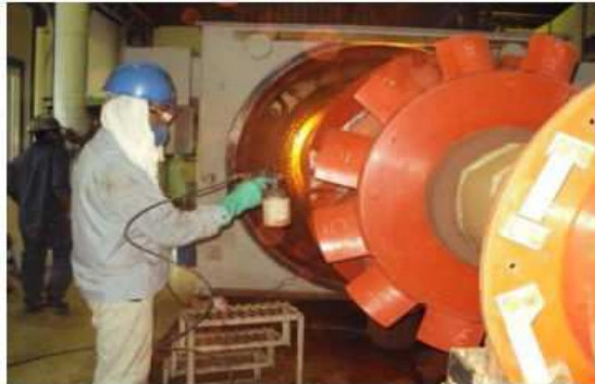
Figura 3.30 – Aplicação de verniz no rotor da máquina
