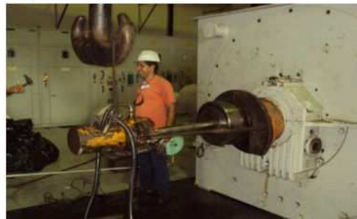
Figura 3.18 – Remoção da luva de acoplamento
