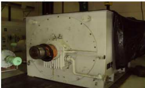
Figura 3.18 – Remoção da luva de acoplamento
