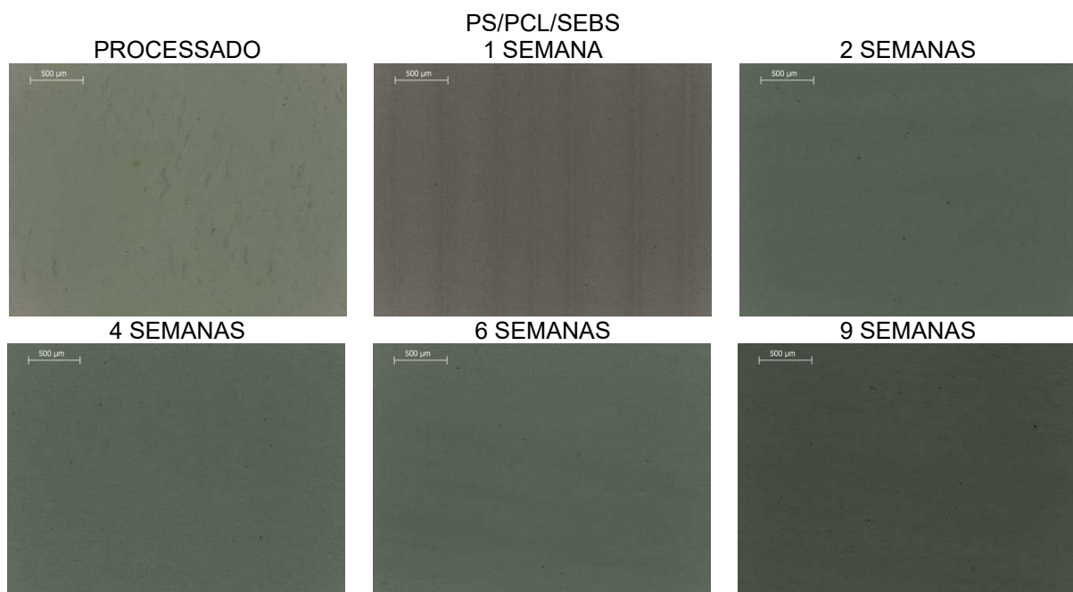
Figura 34 - Micrografias obtidas por Microscopia Ótica para a blenda PS/PCL/SEBS após diferentes intervalos de fotodegradação.
