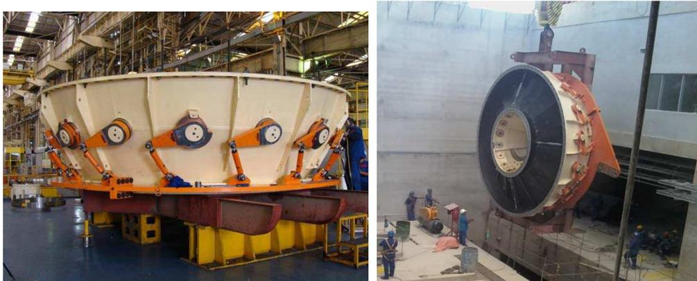
Figura 2- Distribuidor da PCH Queluz-SP.
